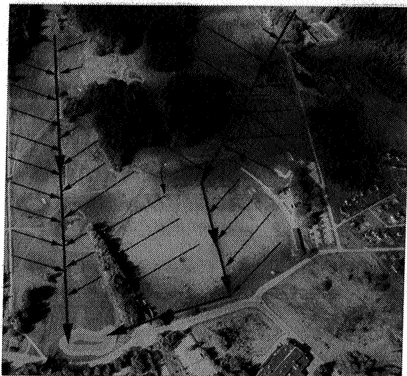
Figur 3. Lövstafältets befintliga dräneringssystem åskådliggjort med de mörka pilarna.
