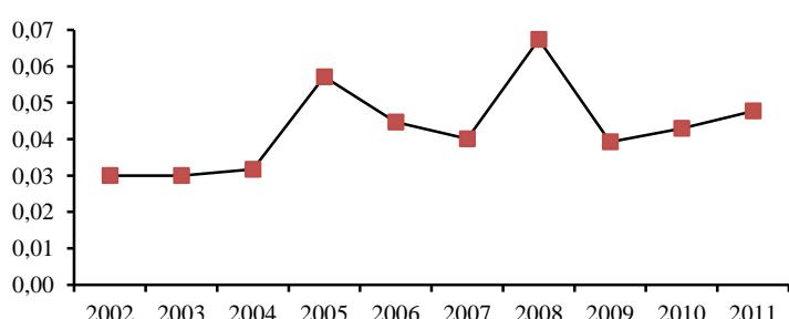
Elförbrukning på avloppsledningsnätet - kWh per behandlad m³ avloppsvatten.
