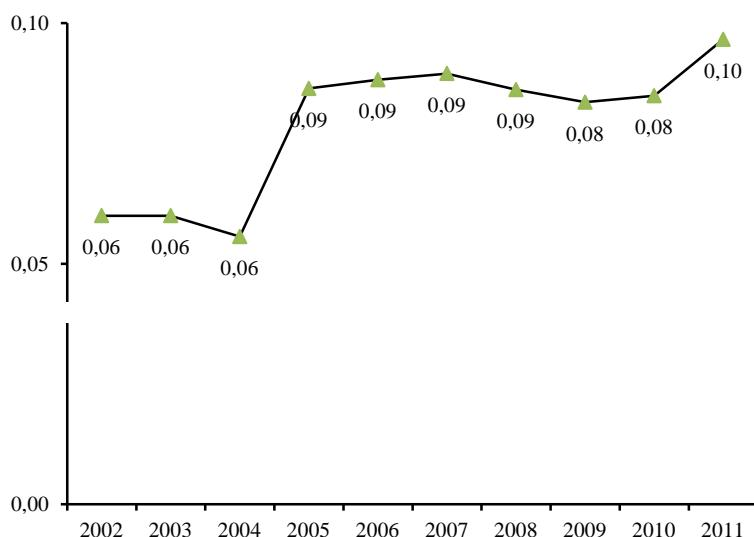
Elförbrukning på vattenledningsnätet - kWh per producerad m<sup>3</sup> dricksvatten.
