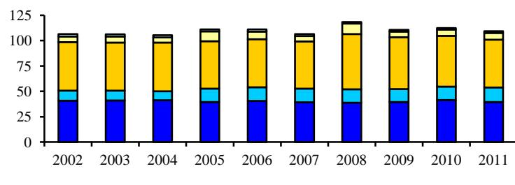
Stockholm Vattens elförbrukning, fördelad på vattenverken, vattenledningsnätet, avloppsverken, avloppsledningsnätet och övrigt - kWh per år och ansluten person.
